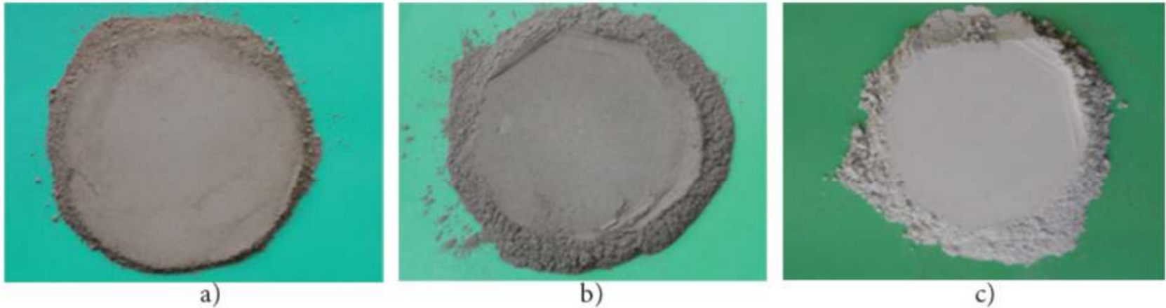
Adições minerais que atuam como filer: a) cinza de lodo de estações de tratamento de esgoto; b) cinza da combustão de eucalipto e c) resíduo de corte de granito.
